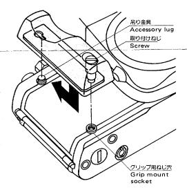
グリップの取り付け方[A・B共通です] グリップ裏側の取り付け穴を、カメラの吊り金 具に合わせて入れ、矢印のように押し上げて取 り付けねじをドライバーか硬貨で十分しめ付け ます。
